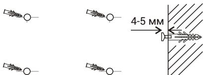
Vissez les supports (2 pcs qui vont avec) au mur derrière de l'appareil avec des vis qui vont avec.
