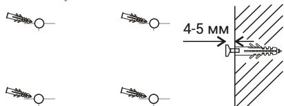
Uchwyty (2 sztuki w komplecie) należy przykręcić do tylnej ścianki urządzenia śrubami z kompletu.
