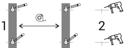
Należy włożyć uchwyty do zrobionych otworów i wkręcić śruby szybkiego montażu, nie dokręcając 5 mm do ściany.
