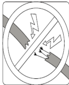
Перевірити цілісність кабелів
